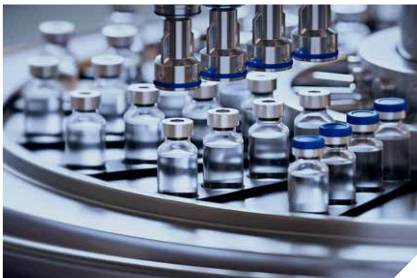
Tappatura di flaconi farmaceutici Pharma small bottles capping Verschließen von pharmazeutischen Fläschchen
