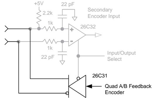
**AS EMULATED QUAD A/B/X ENCODER OUTPUTS FROM AN ANALOG SIN/COS FEEDBACK ENCODER OR RESOLVER**
