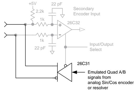
**AS A MASTER OR CAMMING ENCODER INPUT FROM A DIGITAL QUADRATURE ENCODER**
