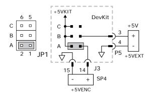
IMPORTANT: ONLY ONE SHORTING PLUG CAN BE USED ON JP1-A or JP1-B POSITIONS USE OF MORE THAN ONE PLUG WILL DAMAGE 5V POWER SUPPLIES IN THE SP4
