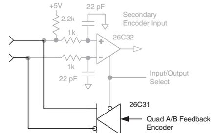
**AS EMULATED QUAD A/B/X ENCODER OUTPUTS FROM AN ANALOG SIN/COS FEEDBACK ENCODER**
