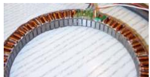
Dünnringstators eines BLDC Innenläufermotors (AD 180 mm)
