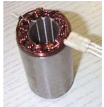
BLDC-Stator für den PKW-Einsatz mit hoher Wickeldichte
