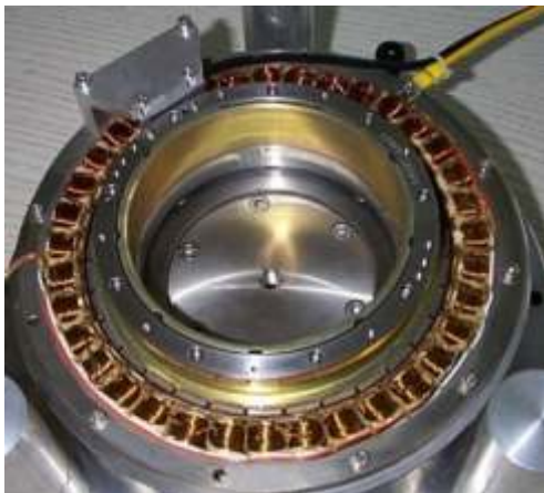
BLDC Innenläufer mit hochauflösendem Geber und integrierter Lagerung
