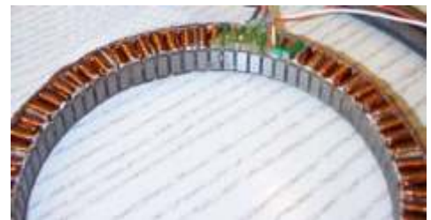
Thin ring stator of a BLDC inner-rotor motor (OD 180 mm)
