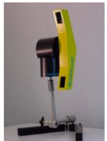
Mobile Scan 3D Tisch Stativ mit 2-Achsenkopf
